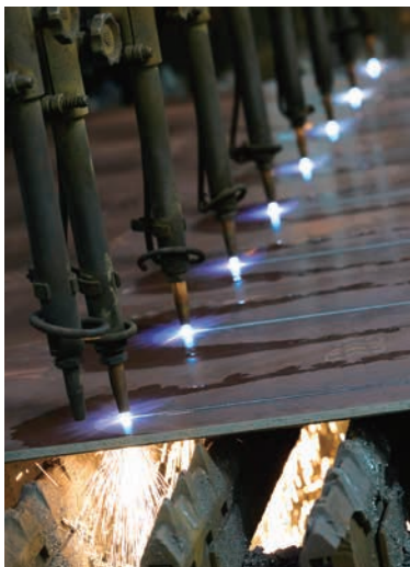
多様な切断技術で1枚の鉄板を無駄なく使い切る
